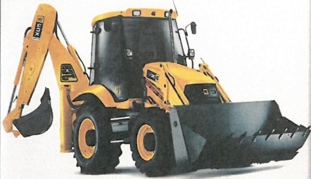
حفارة مع جرافة Backhoe Loader
