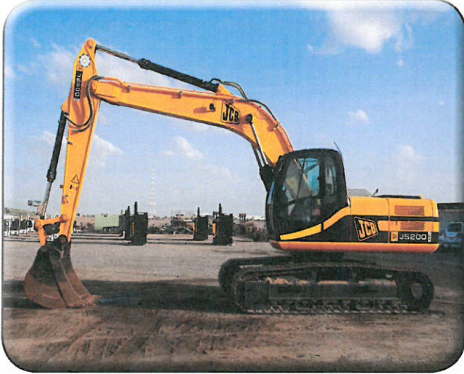
Long Arm Excavator حفارة بوم طويل
